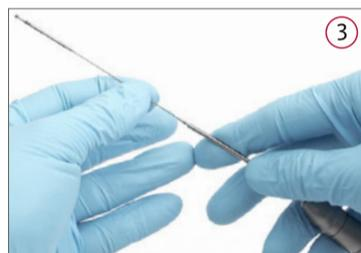
Neues Fräser-Werkzeug durch die Führungshülse einsetzen.
