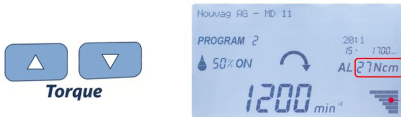
Der Aufbau des Drehmoments wird hier graphisch dargestellt. Beim Erreichen des eingestellten Drehmoments sind alle Elemente des Balkens sichtbar.
