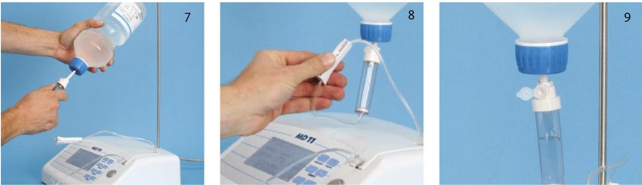
7. Einstechdorn am Anfang des Schlauchsets in die Gummimembran des Verschlusses der Kühlmittelflasche einstecken und Flasche am Stativ aufhängen.
