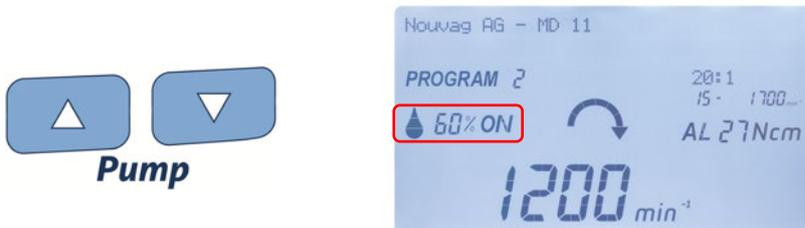
Minimum und Maximum der Pumpen-Fördermenge wie auch die Erhöhungsschritte können im Konfigurationsmenü angepasst werden (siehe «7.8 Konfigurationsmenü, Parameter Level 2, Pump»).
